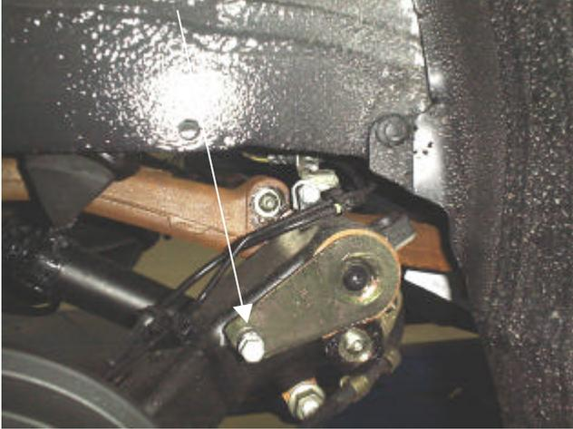
Sicherungsscheiben Drehstäbe entfernen
