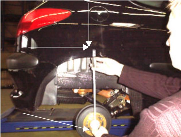
Achsschwinge abstützen und Drehstab mit Schlagauszieher herausziehen. Achsschwinge ca. 30 mm nach oben neu abstützen. Drehstab wieder einführen. Passende Stellung durch Drehen herausfinden. Abstützung entfernen. Achsschwinge leicht durchfedern und Maß kontrollieren. Gleiche Vorgehensweise auf der anderen Seite. In umgekehrter Reihenfolge Drehstäbe wieder sichern und Stabilisator befestigen.
