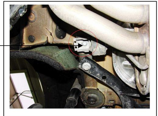
05. Mittellager des Stabilisators links und rechts lösen (4x SW10 Vielzahn), Serienstabilisator nach links aus dem Fahrzeug herausnehmen
